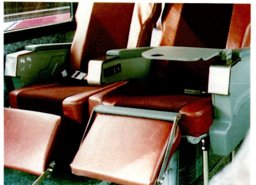
다용도 서비스 패널과 승객 편의를 최대로 고려한 발받침대가 부착된 시트
