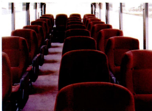
실내 좌석은 3열 배열로 승객의 편의성을 확대했는데, 좌우 무게중심을 최적화하기 위해 운전석쪽에 1열을 배치하고 안내양석쪽에 2열을 배치했다.
