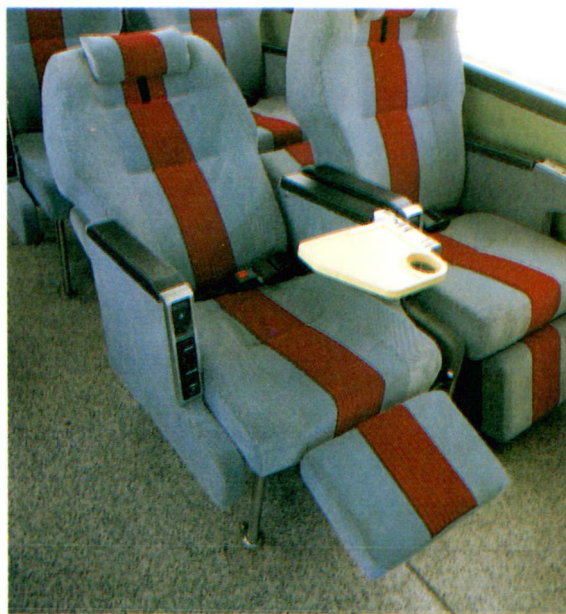
최대 46 등받이 각도 조절기능, 다리 받침대 및 팔 받침대 등이 장착된 베드 타입의 1인용 독립시트, 내장식 테이블 부착
