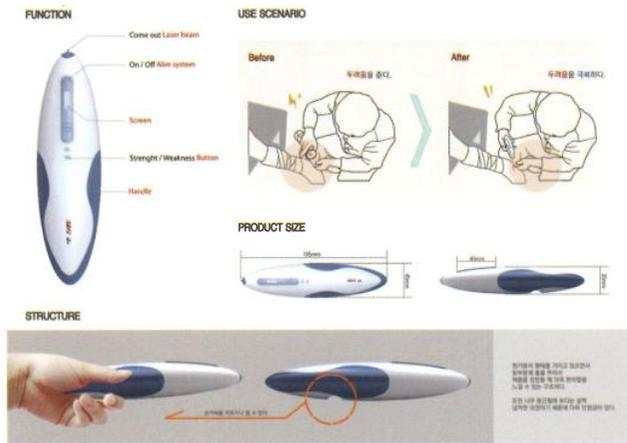
겉스 절단시 안전하게 사용할 수 있는 시스템 Safe Cast Cutter
