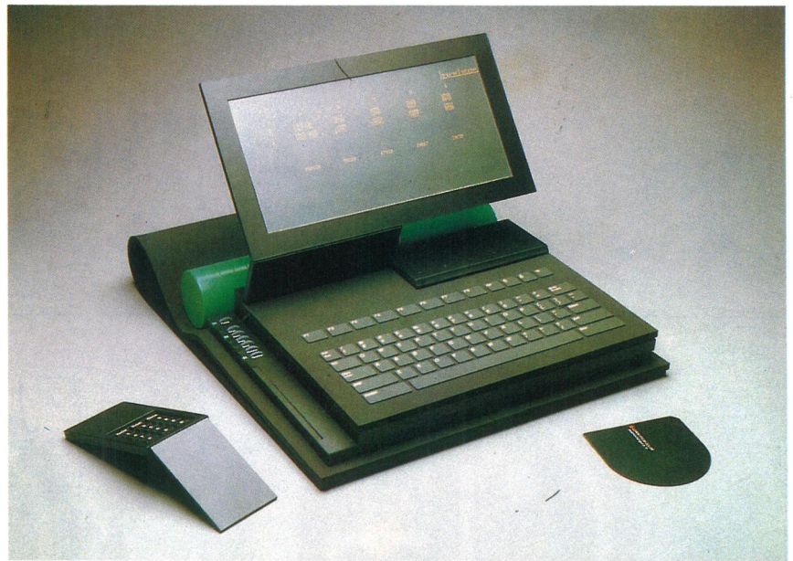
'Portable Office' 컨셉트 컴퓨터 · 전화 · 팩스 · 복사기 · 자동응답기 · 스캐너 · 프린트 를 결합한 사무용기기
