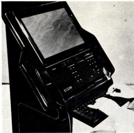
〈사진11〉FAX 및 원고 작성 등 워드 프로세서 기능과 키보드는 자동서랍 방식을 채택
