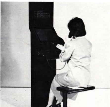
〈사진5〉비디오텍스트나 텔리텍스트 혹은 FAX를 사용할 경우와 같이 장시간을 요하는 경우 앉아서 작동이 가능
