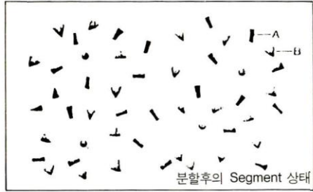
(그림9)극세사의 분할전과 분할후의 원사 상태 및 AITAC의 단면 및 표면사진
