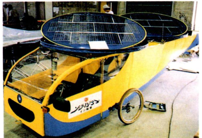
킨키 통상산업국팀 무소의 "Twin Solar" 태양추미식 가변 솔라 패널이 특이하다.
