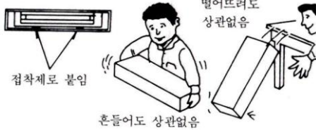
〈그림 4〉 포장방법 개선의 발단 (접착제로 고정하는 것만으로도 좋다고 판단)
