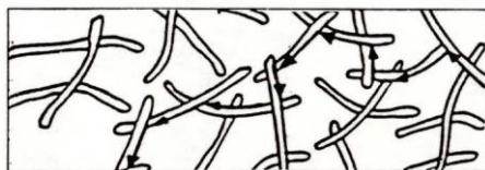
섬유상 필러: 직경 25 \mu\text{m} , 길이 2.5\text{mm} , 5vol% 혼입
