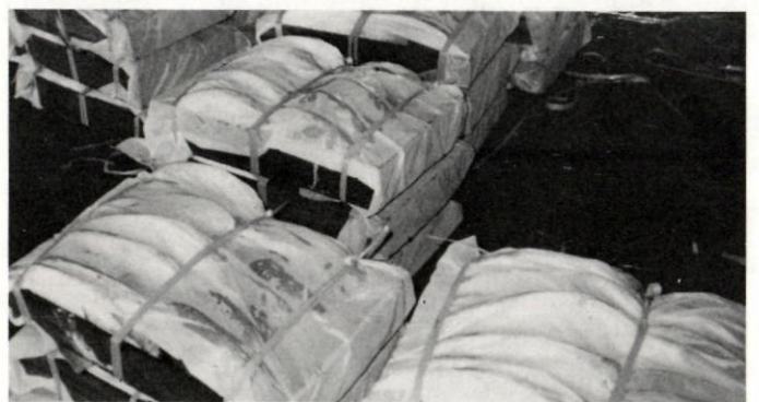
〈사진 42〉 PE Film으로 덮고 PP밴드로 결속된 비교적 깨끗한 輸送箱子이나, 内容物을 많이 넣은 關係로 적재가 어렵고, 적재 순간부터 内容物이 압상을 당하고 있다. (사례 : 군산)
