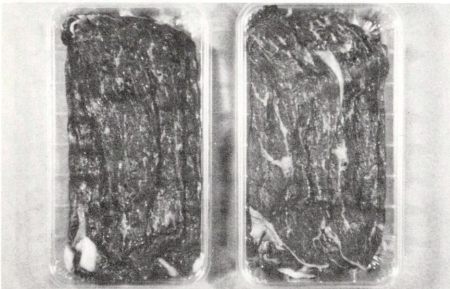
〈사진 2〉 肉類에 대한 EVAL 필름포장(左)과 他 필름포장(右)의 비교. 右는 산소침투로 변색되었음.
