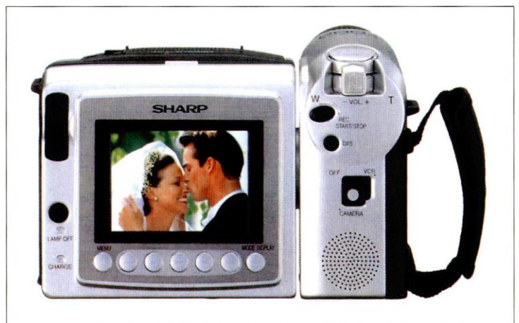
손떨림 보정 기능의 비디오 카메라. 압전세라믹스는 손떨림에 의해 발생하는 기계적 진동을 감지하고 이를 완화시킬 수 있는 손떨림 방지장치를 작동시켜 화면 떨림을 없앤다.
