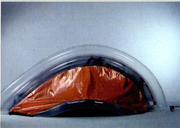
말려져 있는 코쿰을 펴 공기를 주입한 다음 에어 빔을 끼우면 손쉽게 텐트가 완성되는데 그 부피가 사용하지 않을 때의 거의 10배에 가깝다. (2300 x 800 x 900 mm, 약 1,300g)
