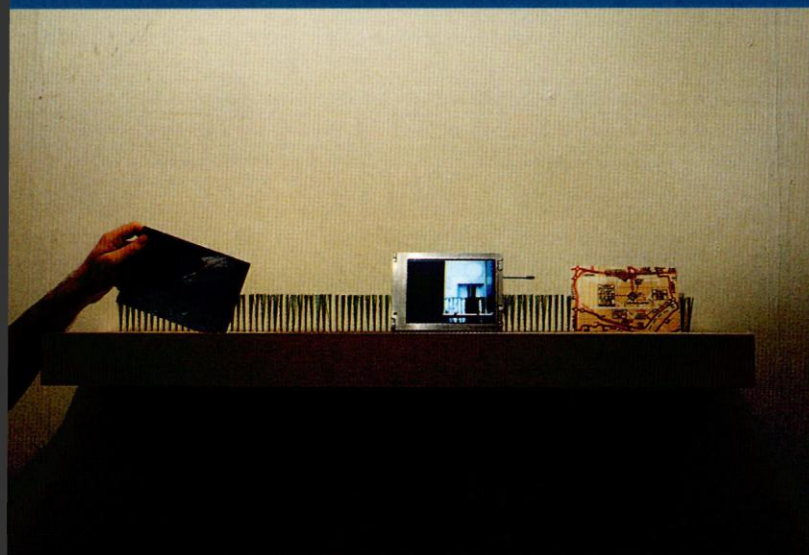
디지털 선반 Digital Shelf, 1999년. 디자인 / 헤더 마틴 & 빌 게이머, 클라이언트 / 휴렛 팩커드 선반은 각각의 포스트카드로부터 소리를 재생할 수 있을 뿐 아니라 이 소리와 형상을 디지털 포토 앨범과 같은 형태로 저장할 수도 있어야 한다는 것이었다. 오디오 포스트카드를 선반의 왼쪽 사이드 위의 좁은 홈에 끼움으로써 각 카드에 연결된 소리를 재생할 수 있게 된다. 소리가 재생되는 동안 그 카드로부터 나오는 소리와 형상 모두가 내부 스피커를 통해 디지털로 선반에 전달되며 동시에 작은 스크린에 나타난다.
