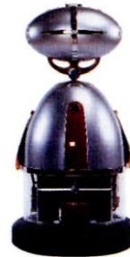
'콤 라인' (Komm-Rein! : 어서 오세요!) 방문객들에게 다가가 '어서 오세요!'라는 인사 말과 함께 전시회에 대한 짧은 안내를 하는 엔터 테인먼트용 로봇. 아래쪽에 설치된 레이저 장치 로 사람의 두 다리를 인식할 수 있도록 프로그래밍 되어 있는 이 '콤 라인'의 턱바퀴 같은 머리는 미용실 머리말리기로 되어 있으며 180도 회전 이 가능하다.
