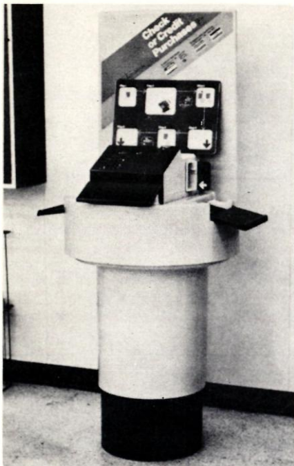
수표와 크레딧 카드는 모두 3단계에서 처리된다. 그리고 기계의 전자 공학적 부품들은 조적대의 중앙에 위치해 있다. (아래 그림) 주요부는 섬유 유리(Fiber Glass)로 제작되었으며, 최종적인 이용 방법은 여섯 단계를 거치게 되었다.
