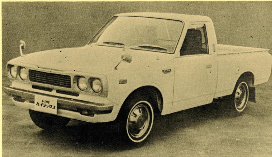
하이릭스 RN20형 트럭 : 이것은 국내 내수용 1600cc 표준형이고 수출용은 2000cc 매뉴얼과 오토매틱이 있다.
