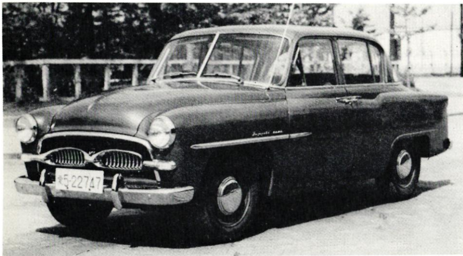
RS형 승용차 도요렛 크라운 : 윈드실드 글래스 (Windshield Glass)는 2분할, 리어 윈도우(Rear Window)는 3분할되어 있다. 1년후에 디렉스가 나오면서 1매 유리가 되었다.
