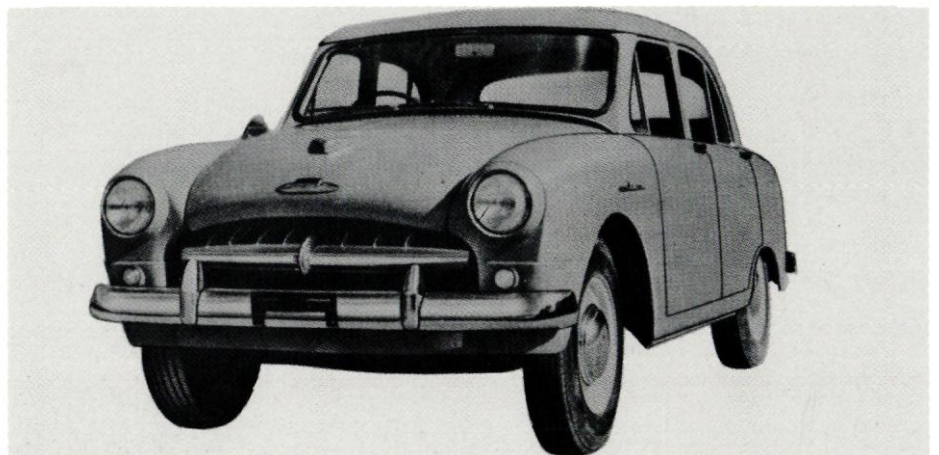
RR형 승용차 도요렛 마스터. 윈드실드 글래스 (Windshield Glass)는 곡면 유리처럼 보이나 실은 평면 유리이다. 헨더(Fender)와 본넷(Bonnet)의 끝선과 면의 끝선을 일치시키거나 엔진 후드(Engine Hood) 카울(Cowl)에 단차(段差)를 만들고 거기에 환기장치(Ventilation)의 구멍을 만들어 생산성과 디자인을 적합하게 하였다.
