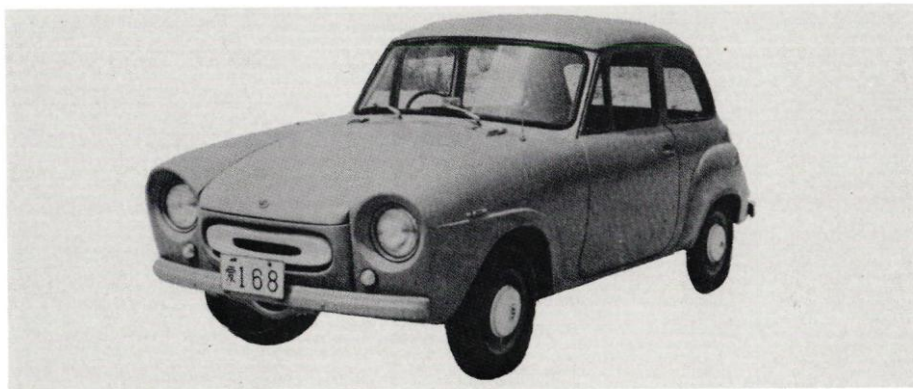
1A 퍼블리카의 프로토타입(prototype) 1호차 : 엔진은 퍼블리카 UP10의 원형, 공평 2기통 수평대양(水平対向) 700cc 엔진이나 구동형식은 프론트 엔진, 프론트 드라이브 방식이다.
