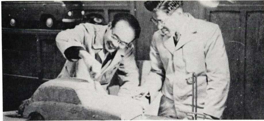
1A의 1/5 스케일 클레이 모델을 만드는 후지하라군과 필자 : 매우 다정해 보이지만 아직 디자인의 관리 체제가 정비되지 못했던 시대에 두명이 하나의 작업을 하는 데 있어서 인간적인 커뮤니케이션의 어려움도 체험했다.
