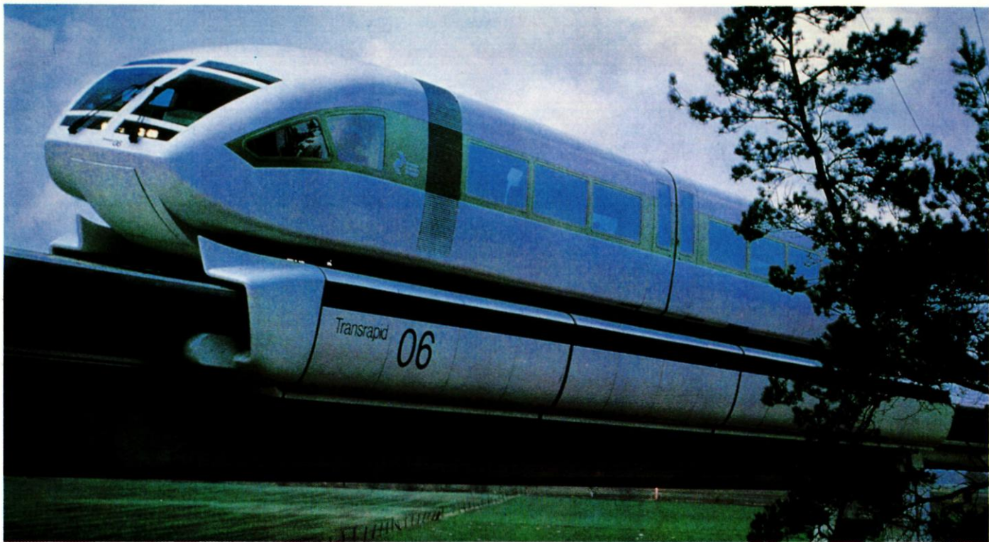
9. “Transrapid 06”은 트랙에서 10mm 위로 떨어진 채 미끄러져 간다. Transrapid 05의 디자인을 보면, 승객 이용 구역과 차대받이 장치가 분명히 구분되어 있는 반면에, Transrapid 06은 하나에 다른 하나를 얹어 한
