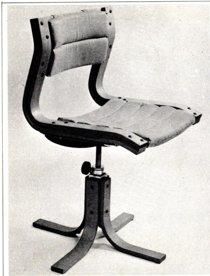
라미네이트된 나무를 이용하여 디자인된 작업용 의자의 워킹 모델
