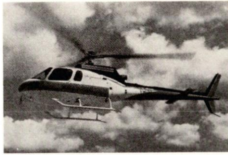
유리 섬유 강화 폴리카아보네이트를 외장재 및 구조재로 사용한 헬리콥터
