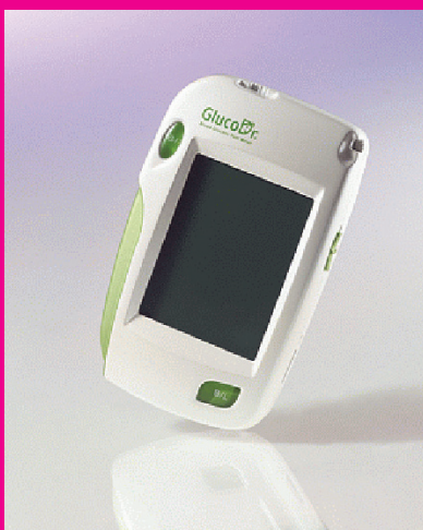
사용자가 고령자임을 감안한 큰 LCD창과 작동이 용이하게끔 인터페이스 버튼을 단순화한 '병원용 혈당기'
