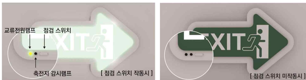
그림 3.29 방향성 비상구 유도등의 스위치 작동
