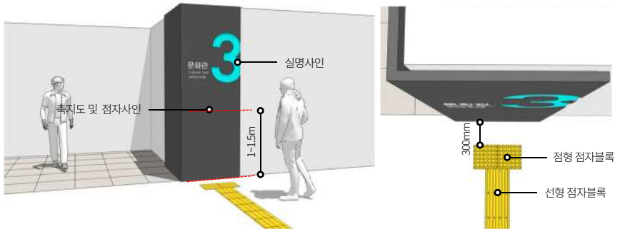
전시실 출입구 우측에 전시관람 동선을 안내하는 점자사인 및 실명사인을 결합하여 설치한 예시
