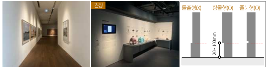
지양: 걸레받이를 설치하지 않은 사례 권장: 걸레받이가 설치된 사례 걸레받이 설치 유형
