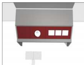
근거리 접근이 필요한 감각전시물 전면 점형 점자블록 설치
