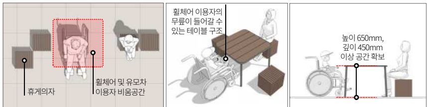
휠체어 및 유모차 이용자를 배려한 공간 조성 휠체어 이용자를 배려한 테이블 하부구조
