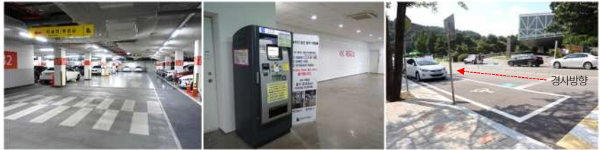
노면 포장색을 구분하여 보행동선 확보 휠체어이용자에 높은 주차정산지 경사로 양면에 평행 주차구역 배치
