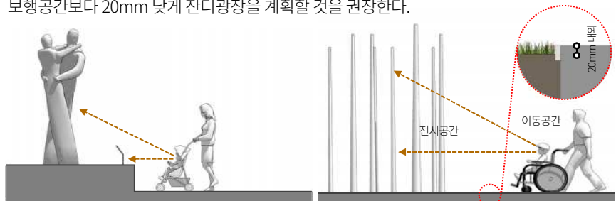
지양: 전시공간의 바닥면이 보도보다 높아 어린이, 휠체어 이용자의 시야에서 벗어나는 전시물의 예시 권장: 전시물을 배치한 조경공간과 관람동선 사이의 단차를 20mm 내외로 조성한 예시
