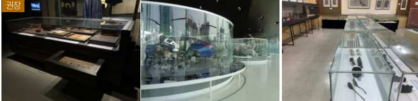
권장: 저반사 유리와 모서리 기계 가공 지양: 반사도가 높은 유리 사용 지양: 유리모서리에 고무 몰딩 부착
