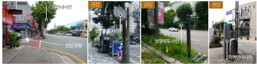
지양: 시인성이 낮은 시설안내사인 권장: 지주형 방향유도사인 및 현위치를 중심으로 설치된 지역안내사인
