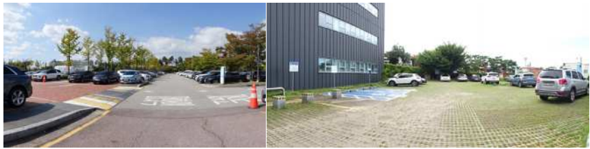
이용자의 야외심터를 차량이 점유하여 보행동선 단절 노면 전체를 잔디블록으로 마감하여 휠체어 및 유모차의 통행 불편
