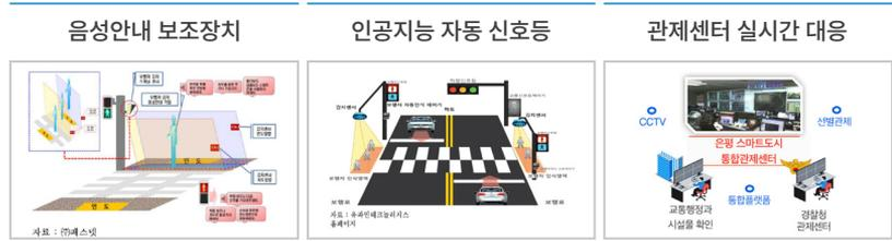
음성안내 보조장치 시스템을 설치해 어린이가 무단횡단을 할 경우 경보방송을 송출해 현재 등·하교시간 녹색어머니회의 신호 안내 보조 역할을 할 수 있도록 했습니다. 또한 야간 신호등 점멸이 어린이 교통안전을 위협하고 있기 때문에 사람을 감지하면 인공지능 신호등으로 자동 변경되는 시스템을 설치해 야간에 어린이 교통사고가 일어나는 것을 막고자 했습니다. 횡단보도에 지능형 CCTV를 설치하고 스마트도시 통합관제센터와 연계하여 스마트 교통시설물을 24시간 실시간으로 모니터링할 수 있도록 체계를 구축했습니다.
