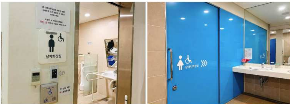
화장실에 텍스트와 심볼을 활용하여 실의 기능, 사용대상, 문열림 방향 등을 직관적으로 인지할 수 있도록 설치
