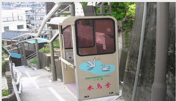
참고 경사지에 설치된 현수형 경사면 이송시스템
