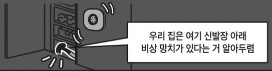
화재가 났을 때는 연기로 인해서 앞이 잘 보이지 않는 경우가 많아요. 그러다 보면 당황해서 구난 용품의 위치를 찾지 못해 초기 대응에 실패하는 경우가 있죠. '안전 경보 음성장치'는 소화기나 망치 같은 구난 용품이 있는 곳에 부착해서 화재가 발생하면 음성과 불빛으로 위치를 알려준답니다. 이 장치는 연기감지센서를 사용해서 작동해요. 가정에서 평상시에 잘 사용하지 않는 안전장치의 위치를 음성으로 알려주니, 화재가 발생했을 때 초기 대응을 할 수 있답니다. 또한, 고시원이나 여관처럼 많은 사람들이 밀집해서 머무는 곳에 설치해두면 더욱 안전을 지킬 수 있습니다.
