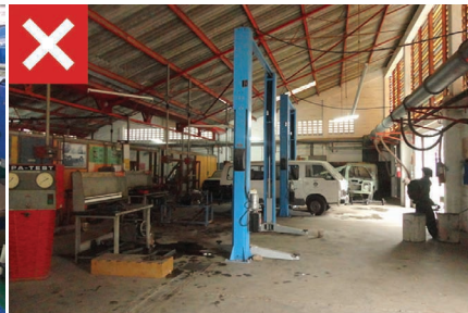
안전한 통로 확보의 부재
