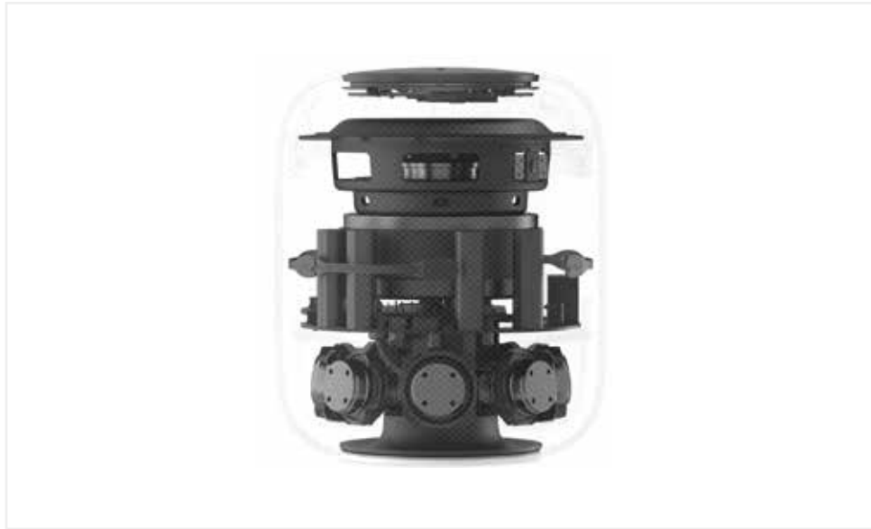
그림 11 _ 애플 홈팟의 내부 구조 [출처: 애플 홈페이지]
