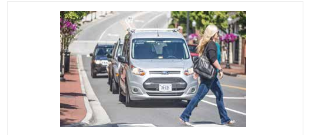
그림 8 _ 빛으로 표시한 상단 바가 자동차의 상황을 표현하게 한 포드의 신호 방식 [출처: 포드]
