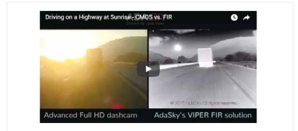
그림 5 _ 기존 카메라와 열 화상 카메라 기반 비전 시스템 비교 [출처: 애다스카이]
