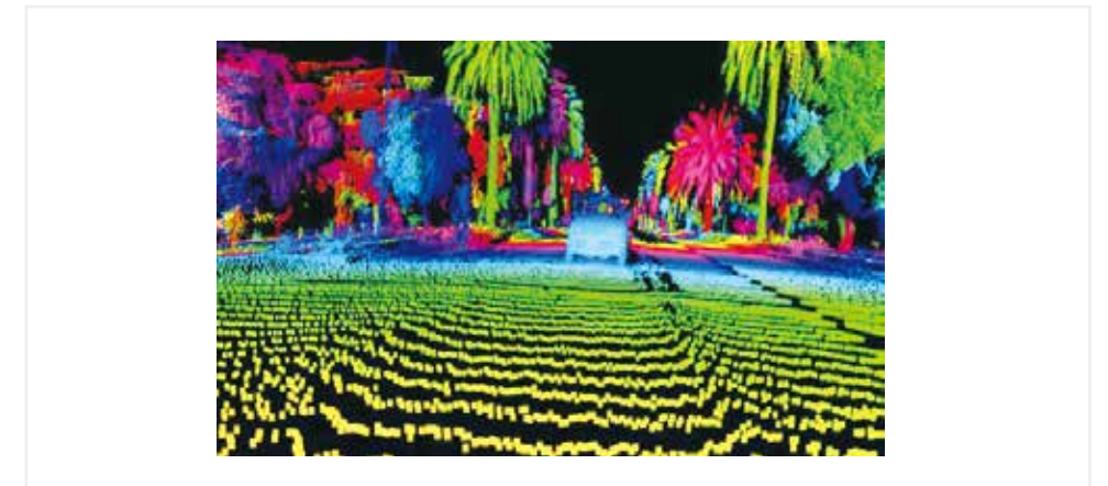
그림 3 _ 라이더로 스캔한 도로 환경의 모습
